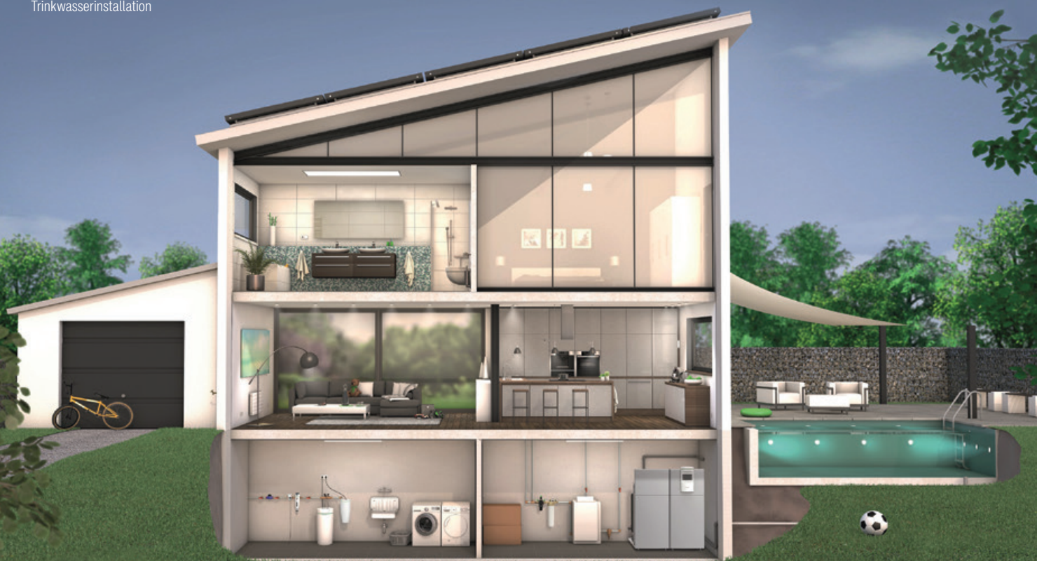
Abb. 1: Einsatz von Enthärtungsanlagen in der Trinkwasserinstallation
