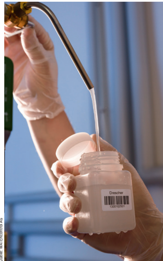
Abb. 1: Probenahme am Trinkwasserspeicher zur systemischen Untersuchung
