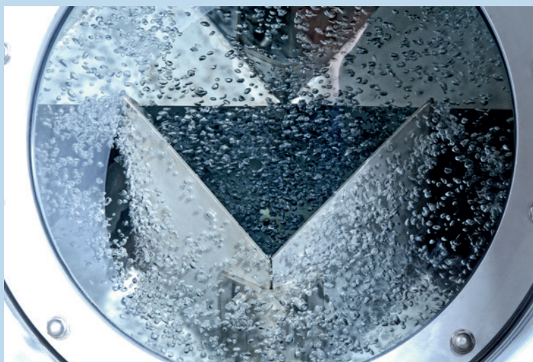
Bild 4. Mischkammer einer Ozonanlage. © Xylem Services GmbH
