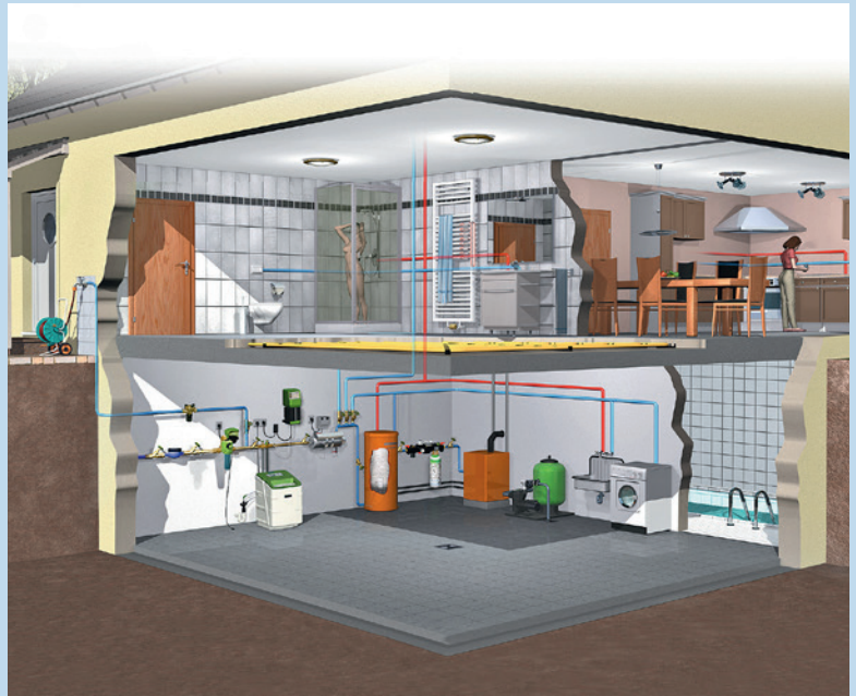
Bild 1. Wasserbehandlungsanlage in einem Wohnhaus zur Vermeidung von Kalkablagerungen. © Grünbeck Wasseraufbereitung GmbH
